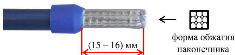
Рисунок 9.1 – Пример обжатия многожильного провода
