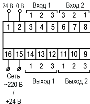
Рисунок 5.5 – Общая схема подключения 2TPM1 Щ5 в модификации 24 В
