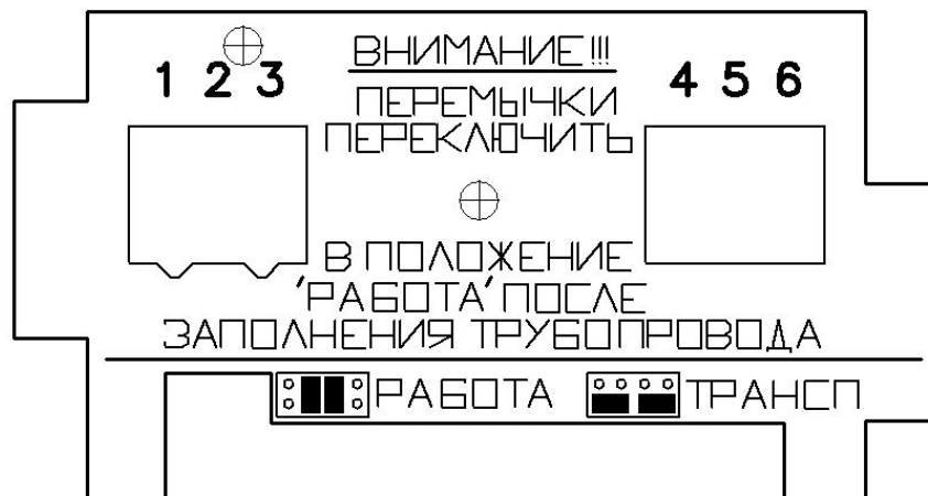
Рис.6 Вид клеммной коробки первичного преобразователя расхода в исполнении Н
