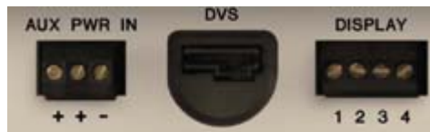
Рис. 5-4. Подключение дисплея к базовому блоку
